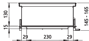
Seitenansicht mit eingebauter Kondensatpumpe
