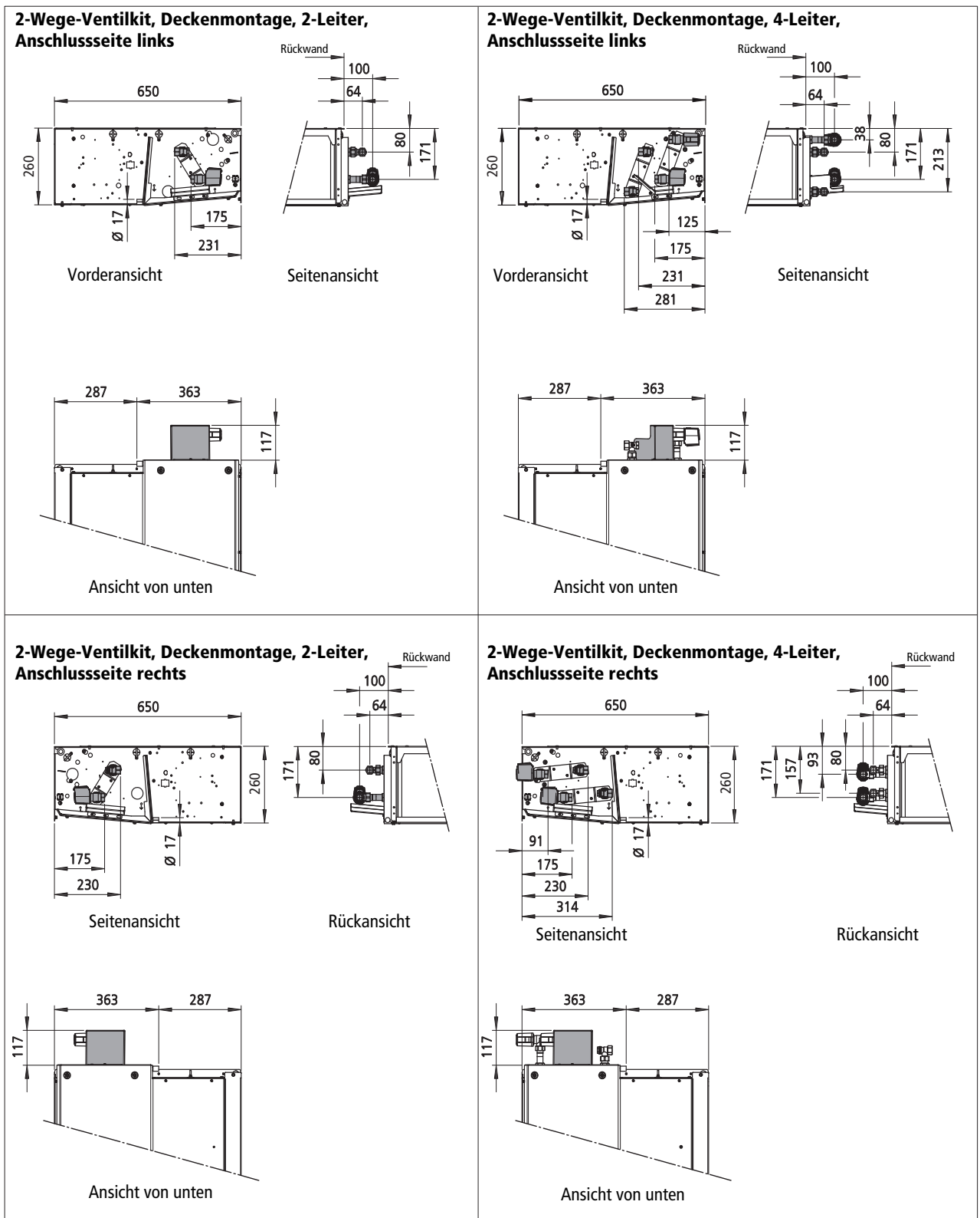
Abb. 12: Abmessungen 2-Wege-Ventilkit (Deckenausführung)
