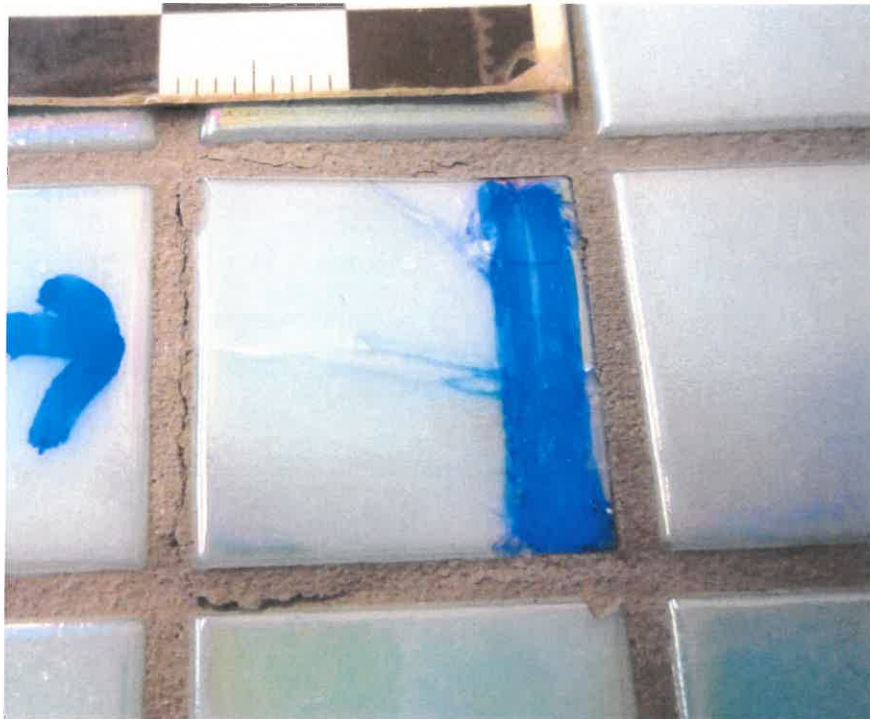
Bild 9: Bild der Fliese nach Versuch Nr. 2 mit linienförmiger Belastung
