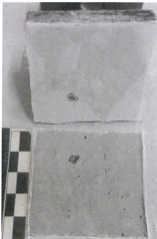
Bild 2: Bruchbild der Haftzugprüfung Nr. 4 an der Probe FL 3 (untere Gewebelage)
