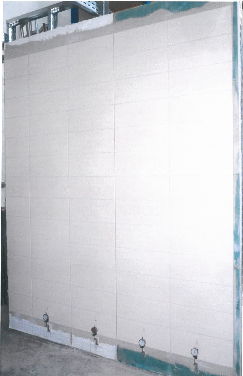
Bild 5: Musterwand mit den Messuhren zur Ermittlung der vertikalen Verformungen der Musterflächen
