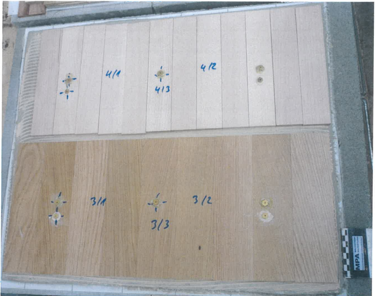
Bild 2: Prüfplatte mit frei beweglichen Holzbelägen
