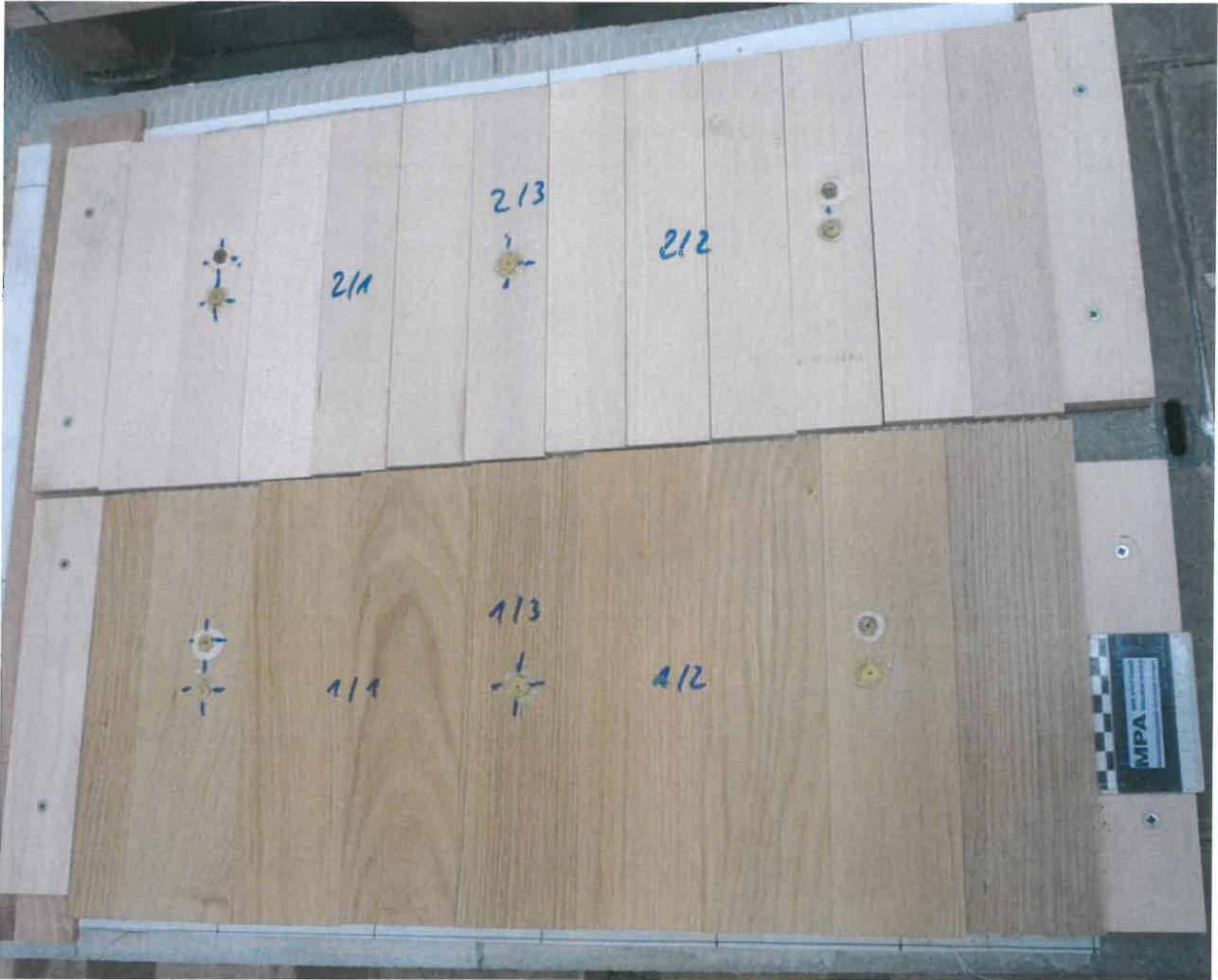
Bild 3: Prüfplatte mit zweiseitig eingespannten Holzbelägen
