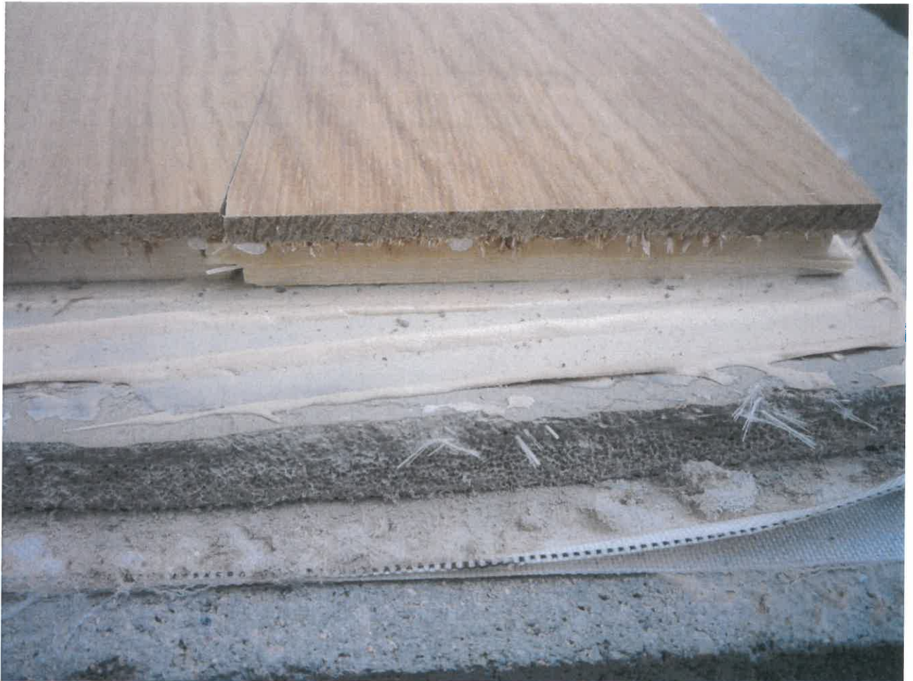
Bild 4: Prüfkörperaufbau mit zweischichtigem Fertigparkett mit Decklage in Eiche
