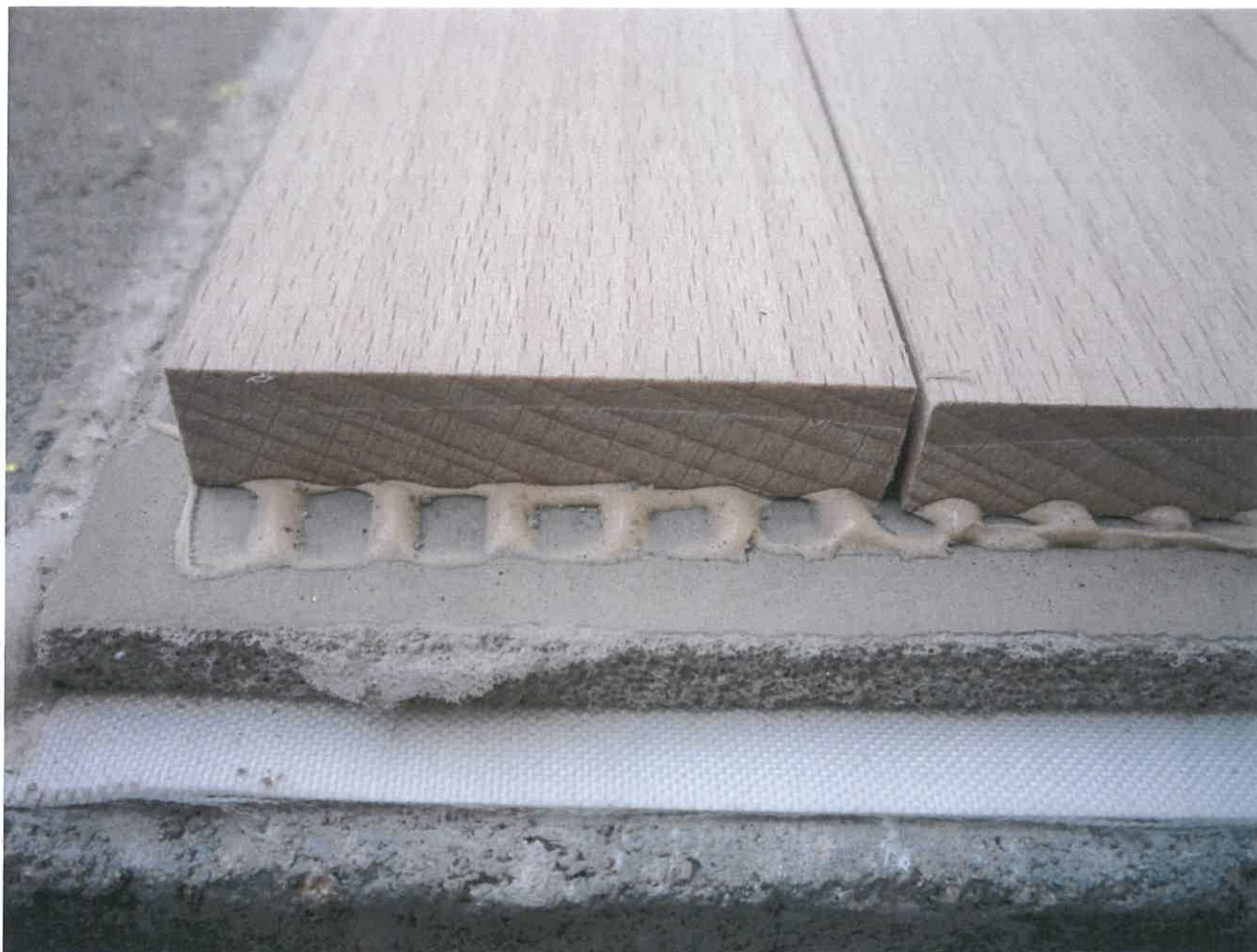
Bild 5: Prüfkörperaufbau mit Massivparkett 250 x 50 x 10 mm in Buche
