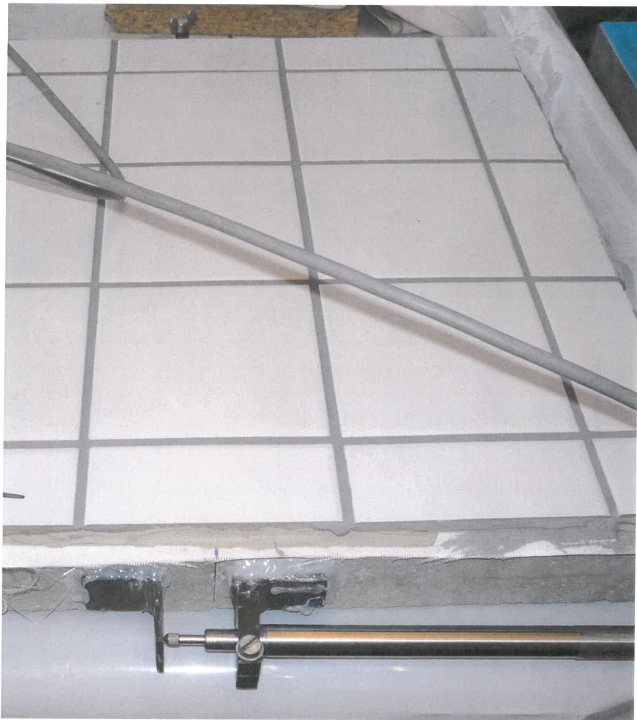
Bild 5: Prüfkörper der Probe mit Fliese über Riss nach der Ermittlung der rissüberbrückenden Wirkung
