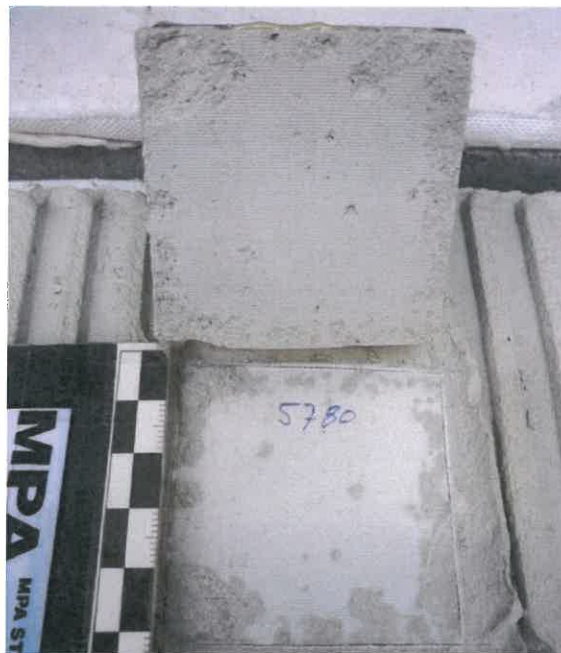
Bild 4: Exemplarisches Bruchbild der Haftzugprüfung Nr. 10 des Prüfkörpers FL 2
