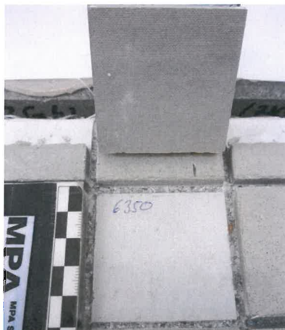
Bild 6: Exemplarisches Bruchbild der Haftzugprüfung Nr. 7 des Prüfkörpers FB 2
