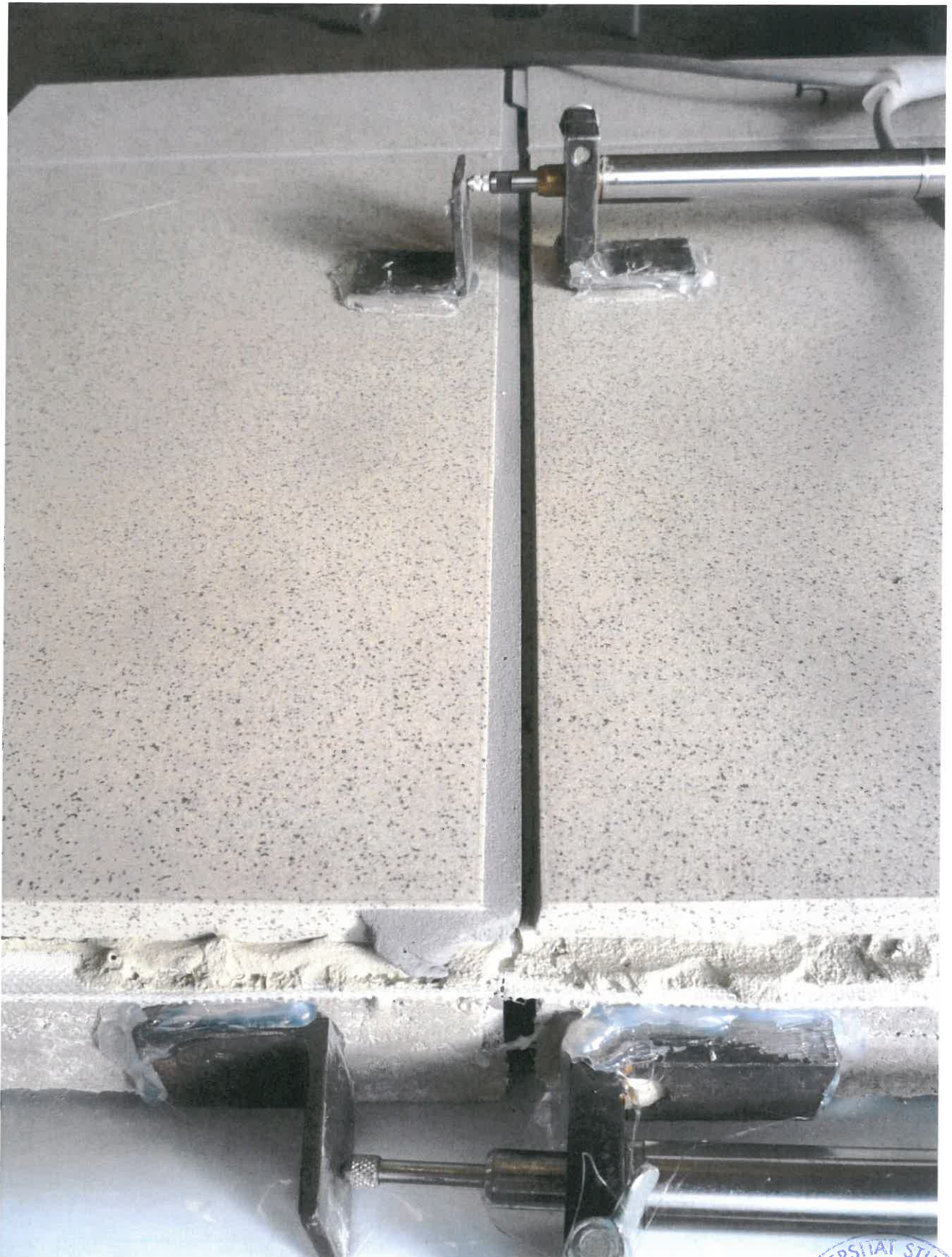
Bild 4: Prüfkörper der Probe mit Fuge über Riss nach der Ermittlung der rissüberbrückenden Wirkung
