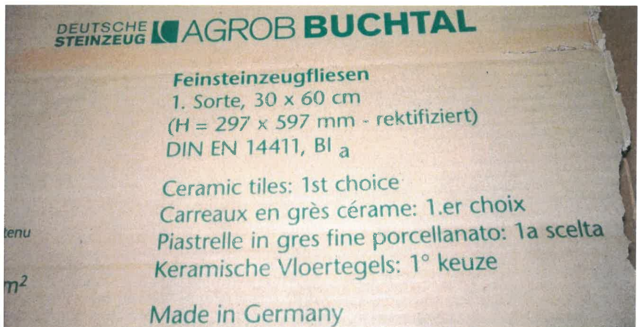
Bild 2: Beschriftung der Verpackung der Feinsteinzeugfliesen Agrob Buchtal 297 x 597 x 10,5 mm
