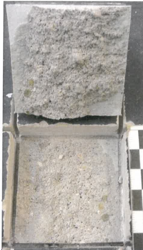
Bild 1: Bruchbild der Haftzugprüfung Nr. 3 bei der Prüfung der Haftzugfestigkeit zwischen unterer Gewebelage der Bodenkonstruktion mit Feinsteinzeugfliese und Untergrund
