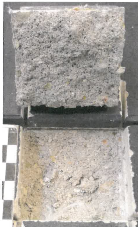
Bild 2: Bruchbild der Haftzugprüfung Nr. 4 bei der Prüfung der Haftzugfestigkeit zwischen unterer Gewebelage der Bodenkonstruktion mit Feinsteinzeugfliese und Untergrund
