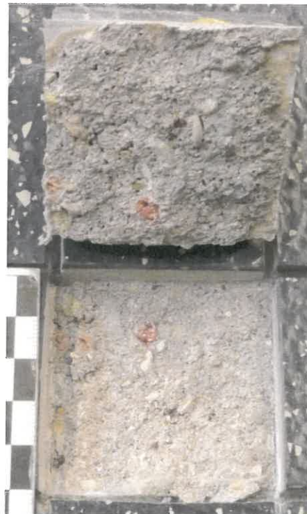
Bild 4: Bruchbild der Haftzugprüfung Nr. 5 bei der Prüfung der Haftzugfestigkeit zwischen unterer Gewebelage der Bodenkonstruktion mit Bodenbelag (Gummibelag) und Untergrund
