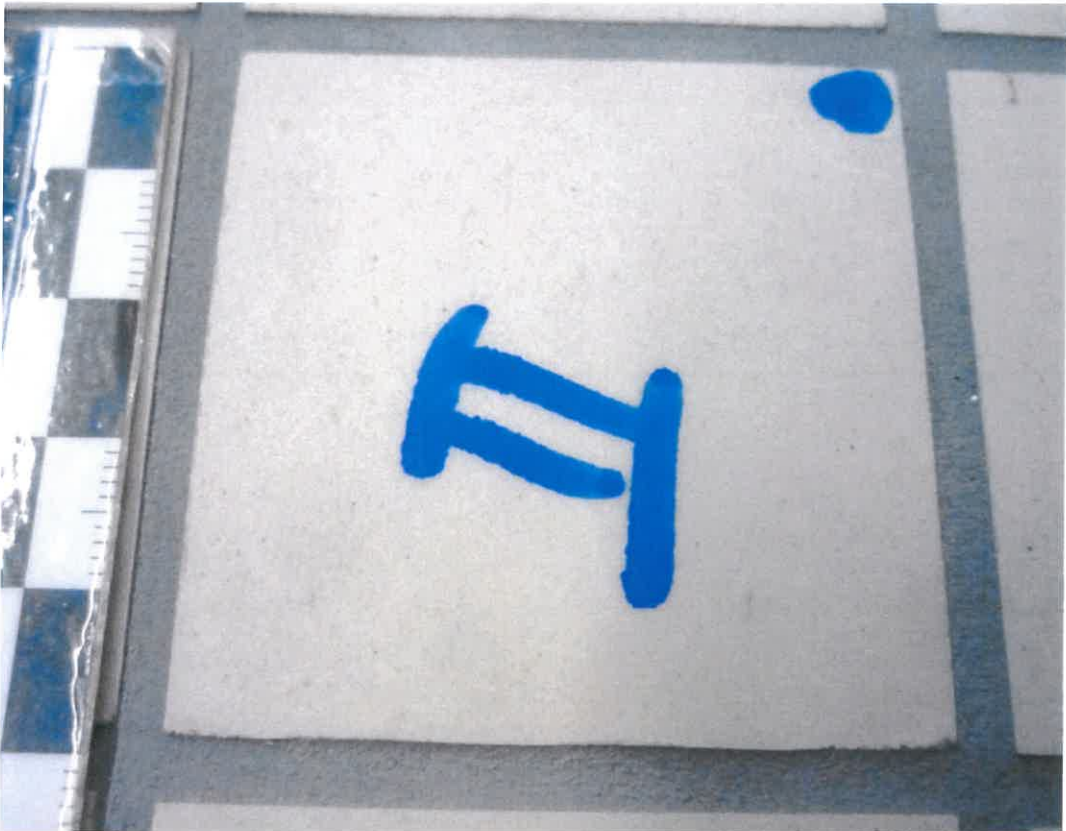
Bild 19: Bild der Fliese nach Versuch Nr. 2 mit Punktbelastung in der Fliesenecke
