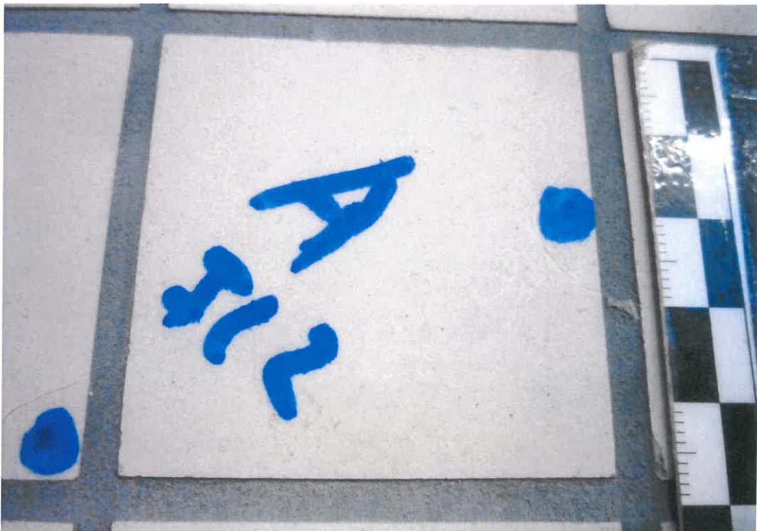
Bild 12: Bild der Fliese nach Versuch Nr. 1 mit Punktbelastung in der Mitte der Fliesen- kante
