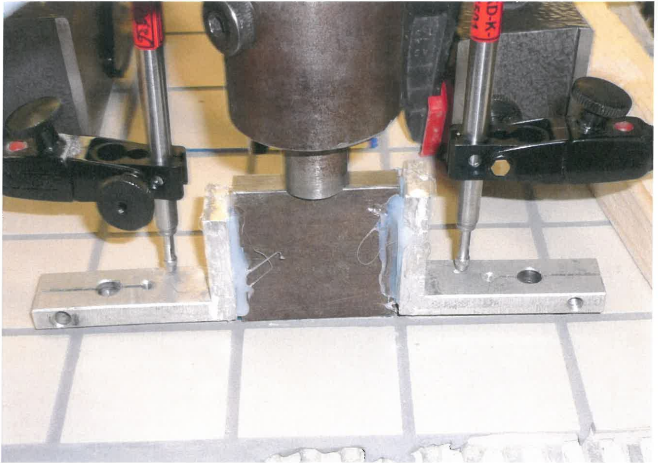
Bild 2: Messung der vertikalen Verformung der Lastschneide bei Linienbelastung mit einer Lastschneide mit einer Länge von 50 mm und einer Breite von 10 mm
