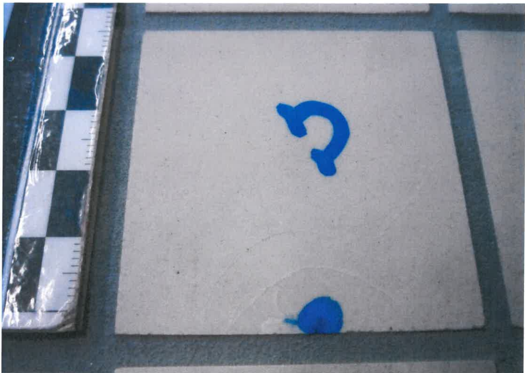
Bild 14: Bild der Fliese nach Versuch Nr. 3 mit Punktbelastung in der Mitte der Fliesenkante
