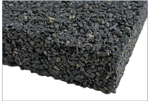
Das Materialgemisch verbindet sich zu einem festen Bauteil mit hoher innerer Dämpfung.
