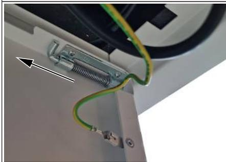
Abb. 10: Scharniere entriegeln
