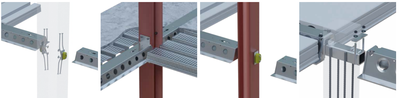
Abbildung 4. Anschluss eines DELTABEAM® an eine Betonfertigteilstütze mit Peikko KPG oder PCs®-Konsole, oder mittels einer verschraubten Endplatte an Stahlstützen
