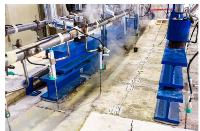
ABB. 8 – AUFBAU DER SYSTEM-BRANDVERSUCHE WÄHREND DER BEFLAMMUNG
