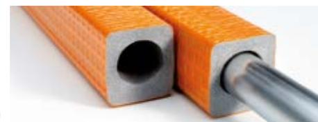
Exzentrisch extrudierte Rohrinsolierung aus geschlossenzelligem Polyethylen-Schaum mit NMC Naturefoam® mit einem Anteil von mindestens 50% nachwachsenden Rohstoffen, mit co-extrudierter PE-Folie.
