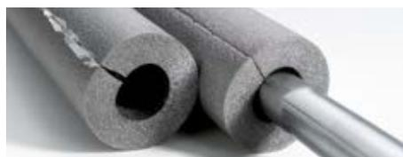
Geschäumtes, geschlossenzelliges Polyethylen mit NMC Naturefoam® mit einem Anteil von mindestens 50% nachwachsenden Rohstoffen mit beidseitig selbstklebendem Verschlussystem.
