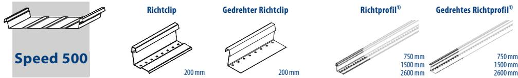
1) Für die Richtprofile und gedrehten Richtprofile darf je Verbindungspunkt eines (gedrehten) Richtprofils mit der Unterkonstruktion der Clipabstand eines Richtclips 200 bzw. eines gedrehten Richtclips 200 angenommen werden. Die Skizze zeigt die Zuordnung der Widerstandgrößen exemplarisch für Richtprofile und gedrehte Richtprofile mit zwei Verbindungspunkten (Auflagern).
