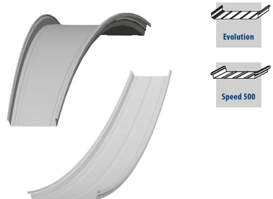
Für bombierte Profilbahnen RIB-ROOF Speed 500 und RIB-ROOF Evolution mit **Radien unter 100 m** müssen zur Befestigung **gedrehte Standardclips/Richtclips** verwendet werden.
