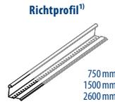
1) Für die Richtprofile darf je Verbindungspunkt eines Richtprofils mit der Unterkonstruktion der Clipabstand eines Richtclips 200 angenommen werden. Die Skizze zeigt die Zuordnung der Widerstandsrößen exemplarisch für Richtprofile mit zwei Verbindungspunkten (Auflagern).
