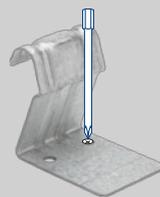
gedrehter Standardclip für RIB-ROOF Speed 500 mit verlängertem Bit-Einsatz montieren
