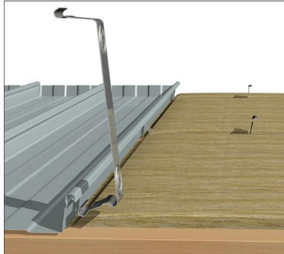
Die Baubreiten sollten während der Verlegung kontrolliert werden. Ab der 2. Clipreihe wird der Standardclip verwendet.
