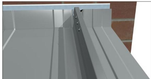
Die Längenausdehnung der Elemente vom Festpunkt zum First ist bei der Ausführung der Firstabdeckung zu berücksichtigen. Für lange Profilbahnen beraten wir Sie gerne bei der Montage eines gleitenden Firstanschlusses mit Richtprofil oder verlängerter Zahnleiste.
