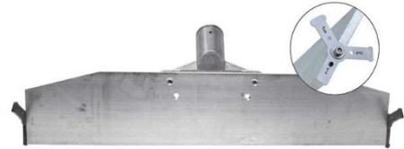
Die Propellerrakel muss 1-2 mm höher eingestellt sein als die gewünschte Schichtdicke.
