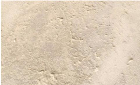
muss CONIPUR 3785 eingesetzt werden. CONIPUR 3785 ist ein Epoxi-Haftvermittler, der in 2 Schichten appliziert werden muss. Die letzte Schicht muss mit Quarzsand abgestreut werden, um die Haftung zur folgenden PUR Schicht zu gewährleisten – weitere Informationen sind im technischen Datenblatt zu finden.
