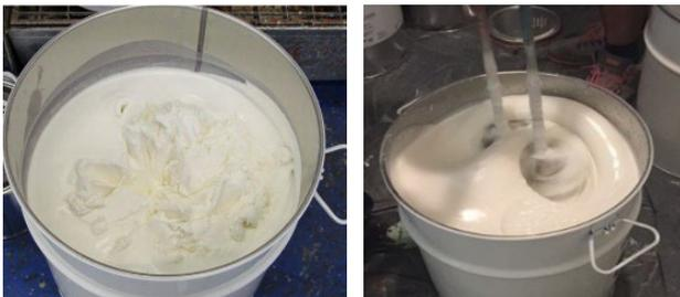
Erst dann wird die B-Komponente in das Gebinde der A-Komponente gefüllt. Dabei ist darauf zu achten, dass die B-Komponente restlos ausläuft.
