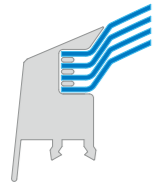
4-schalig U c -Wert 1,5 W/m 2 K U up -Wert 1,4 W/m 2 K
