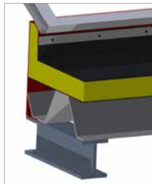
Ausführung freitragende Zarge (Höhen 450, 500, 550, 600 und 650 mm)
