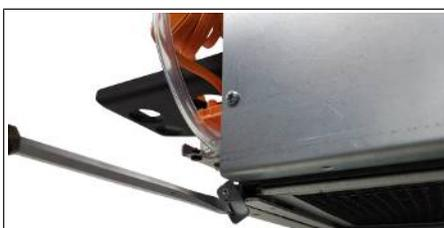
Abb. 64: Drehriegel nach unten drehen
