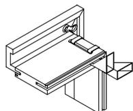
Die konisch geformten Gehrungsschutzecken dienen der Fixierung der Zargengehrungen. Die Schutzecken werden in die Nut für die Zierbekleidung geschoben, wo sie bis zur Aushärtung des Leimes verbleiben.
