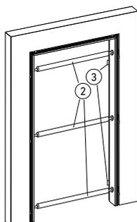
Setzen Sie die Türfutterspreizen an den Band und Schließblechpunkten ein (2) um einwandfreien Sitz zu gewährleisten, und bringen Sie die Zarge mittels Keile in eine lot und waagerechte Position in der Wandöffnung. Bei einem Einsatz von Türblättern mit einem Gewicht < 40 kg muss der Bereich der unteren Bandaufnahme (3) und des oberen Schließblechteil dauerhaft druckfest hin gefüttert werden. Vor dem Verschäumen ist das Zargenfalzmaß auf Höhe der Türfutterspreizen nochmals zu prüfen.
