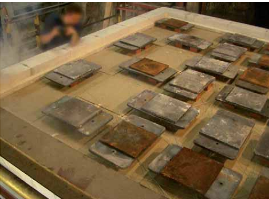
Feuerwiderstandsprüfung eines belasteten Doppelbodens nach DIN 4102/2.
