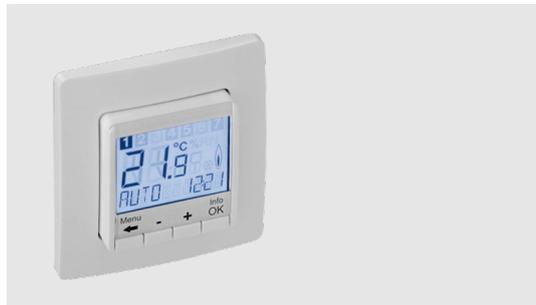
Kombination von Raum- und Uhrenthermostat, in Unterputz-Ausführung, großflächiges Display für Soll- und Istwertanzeige, Bedienfeld mit vier Tasten zur Einstellung von Tages- oder Wochenprogrammen, Partyfunktion, Frostschutz, voreingestellte und anpassbare Zeitprogramme mit automatischer Sommer-/Winterzeitumstellung, max. 9 Schaltzeiten pro Tag mit Blockbildung von Schaltzeiten.
