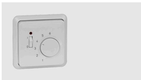
In Unterputz-Ausführung, mit Temperatursollwertgeber, Hauptschalter Ein/Aus mit Kontrollleuchte, thermischer Rückführung und zusätzlichem Schalteingang für Nachtabsenkung (4 K) über eine externe Schaltuhr.
