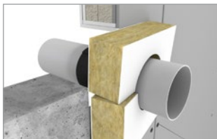
Fachgerechter Einbau des HENSOMASTIK® Kombischotts EI 60
