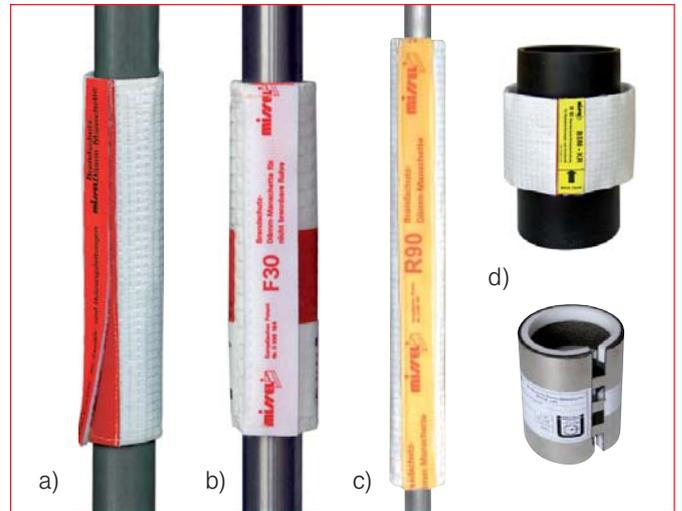
■ **Bild 14** *Brandschutz-Dämm-Manschetten BSM* a) BSM für Abwasser-, Trinkwasser-, und Heizungsleitungen nach MLAR, Abschn. 4.3; b) BSM für Leitungen durch 30-Wände nach MLAR, Abschn. 4.2; c) Klassifizierte BSM für Abwasser-, Trinkwasser-, und Heizungsleitungen; d) Klassifizierte BSM für Abwasserleitungen aus Kunststoff
