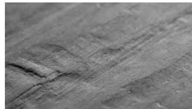
Handhobel-Holzstruktur dokumentiert die Spuren meisterlichen Handwerks
