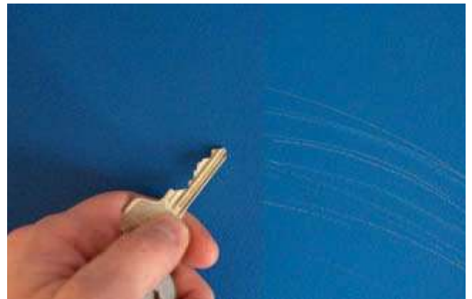
Die Kratzprobe beweist: kein Schreibeffect mit PremiumColor (linke Bildhälfte)
