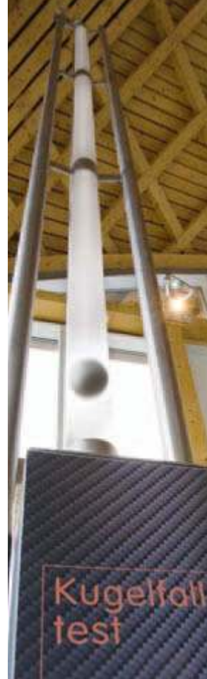
Fallhöhe 5 m, Gewicht 1 kg = 50 Joule: Die Stahlkugel fügt der Carbon-Oberfläche keine Schäden zu
