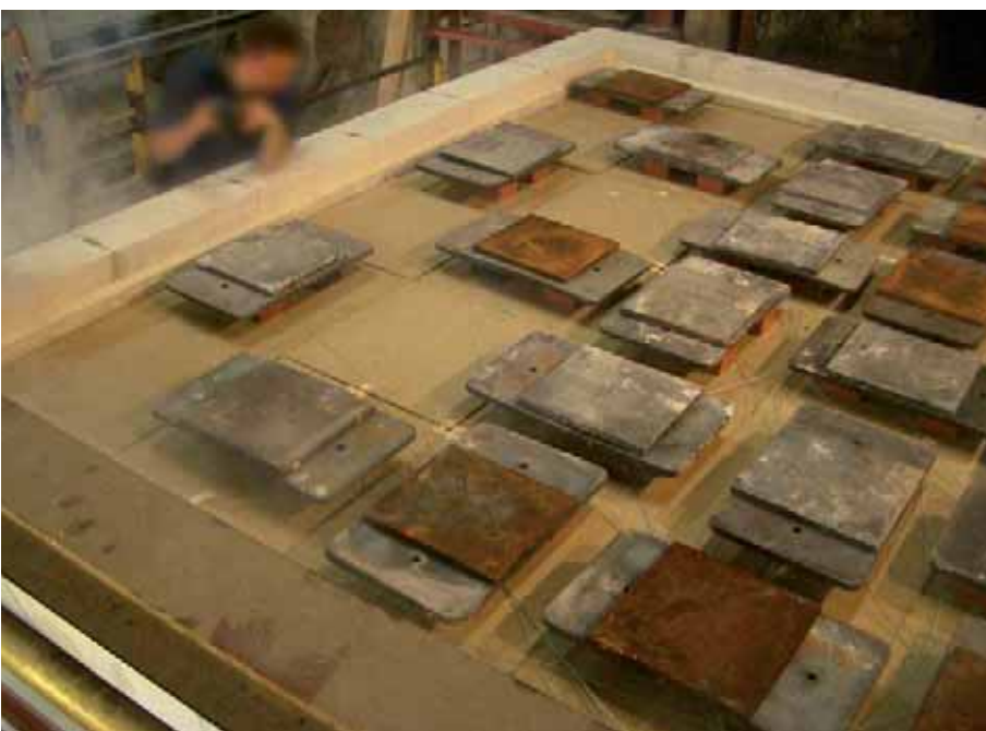
Feuerwiderstandsprüfung eines belasteten Doppelbodens nach DIN 4102/2.
